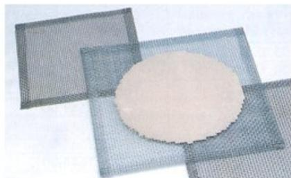
Reticella spargifiamma in ferro zincato disco in ceramica mm 150X150
